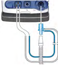
Figura 5-8. Instalación del sensor de flujo, modo nCPAP-PS
