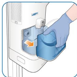
Tire de la cámara hacia fuera del dispositivo.
