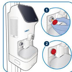
Cubra el adaptador de salida de gas con el tapón de protección.
