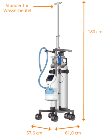
Abbildung 9-2. Abmessungen des HAMILTON-HF90 mit Fahrgestell
