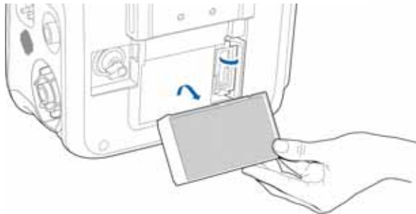
図 10-4. HEPA フィルタの取り外し
