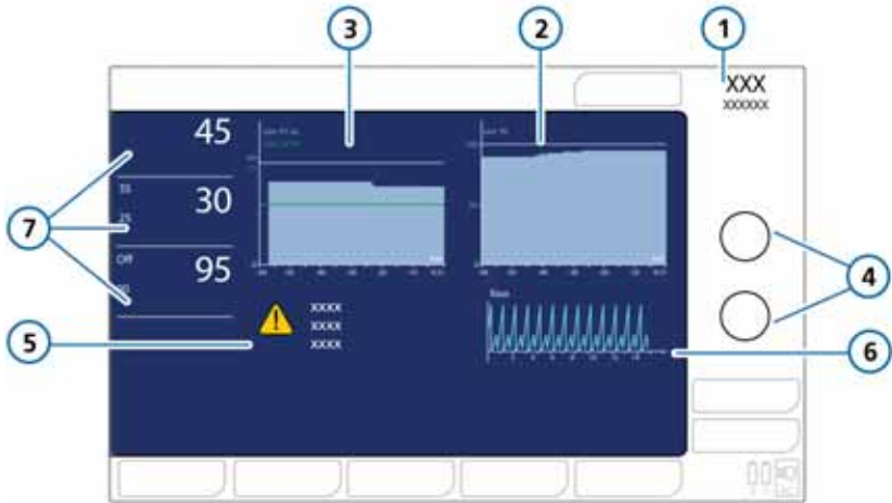
Figura 4-5 Visualización de la terapia con alto flujo de oxígeno
