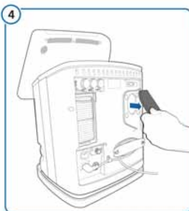
Extraiga el filtro del ventilador y sustitúyalo
