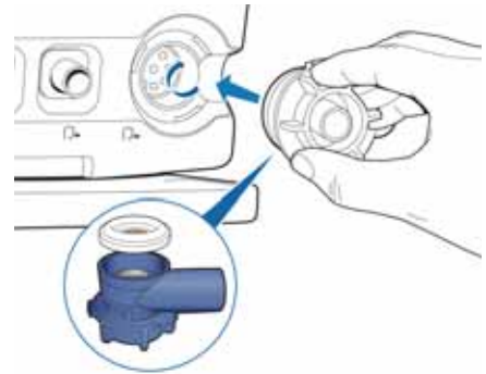
Figura 2-3 Instalación de la válvula espiratoria
