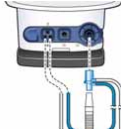
Figura 5-7 Conexión del sensor de flujo a la válvula espiratoria, modo nCPAP-PS
