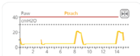
Figure 4-10. Courbes Ptrach et Paw, avec compensation de résistance du tube activée
