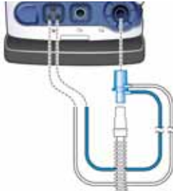
Figure 5-8. Installation du capteur de débit, mode nCPAP-AI
