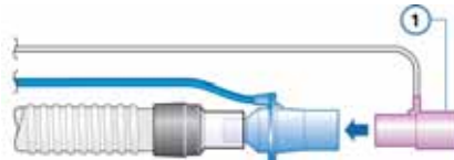
Figure 2-13. Raccordement du capteur de CO 2 (1) à l'adaptateur
