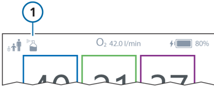
Figure 4-12. Icône de nébuliseur (1) affichée lorsque la nébulisation est active
