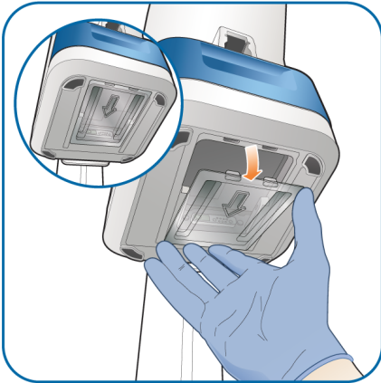
Figure 3-10. Retirez le cache du compartiment de la batterie (en cas d'absence de batterie)
