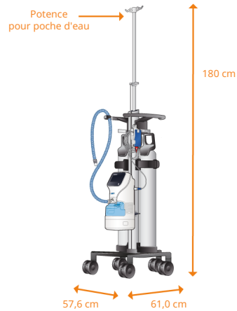
Figure 9-2. Dimensions du HAMILTON-HF90 avec chariot
