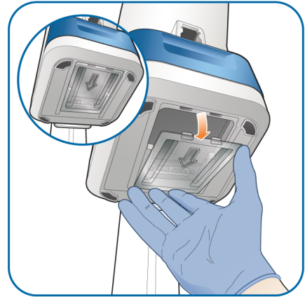
Figura 3-10. Retirada de la tapa de la plataforma de la batería (cuando la batería no está conectada)
